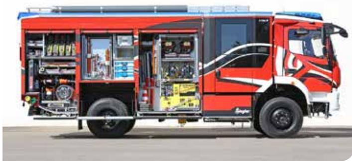
auch spezielle Anforderungen unserer Freiwilligen Feuerwehr mit aufgenommen worden, z.B. 2400 Liter Löschwasser, Allrad-Fahrgestell, Halbautomatikgetriebe, Lagerung PFPN, 4 PA Halterungen im Mannschaftsraum und Rückfahrkamera um nur einige zu nennen.
